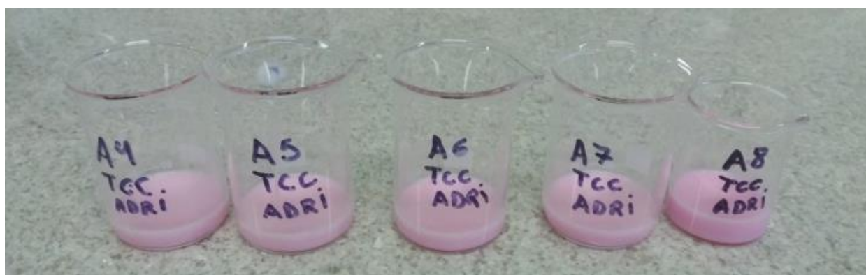
Figura 1: Análise do leite coloração rósea adquirida após adição de solução Dornic. Fonte: arquivo pessoal
