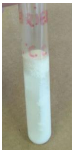
Figura 2: Análise do leite. Resultado do teste de lactofermentação em amostra com coágulo do tipo digerido. Fonte: arquivo pessoal
